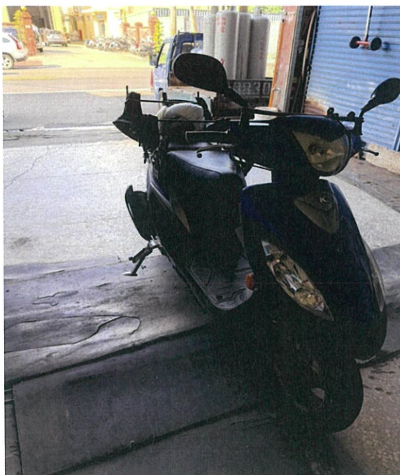
1. 檢查機車側柱或中柱是否穩固。
